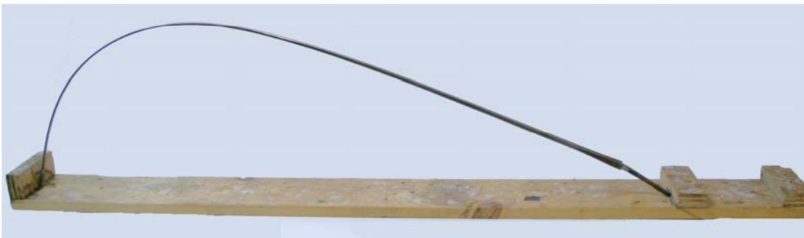
Zum Trocknen wird die Klinge mittels einer Spannschnur leicht gebogen auf ein Brett oder ähnlichem abgelegt oder unter eine Werkbank eingespannt damit sich die neue Litze gut in die Klinge einfügt. Hierbei ist darauf zu achten, dass der Kleber nicht in die Spitze laufen kann. Gut ist es, wenn der Kleber jetzt über Nacht trocknen kann.
