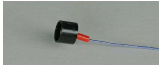
Jetzt führe ich die Litze durch die aufgeschraubte Hülse und schiebe den Isolierbecher mit einem Montagedorn vorsichtig in die Hülse. Hierbei ziehe ich vorsichtig die Litze aus der Unterseite der Hülse.
