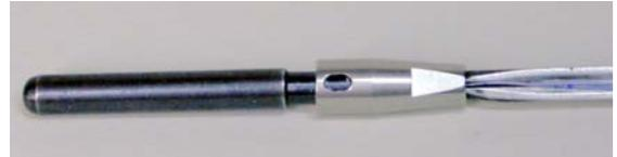
Beim Degen sollen beide Kontakte im Isolierbecher senkrecht zur Klinge eingebaut werden, damit die Litze an der Engstelle zwischen Hülse und Klinge den größt möglichen Freiraum hat.
